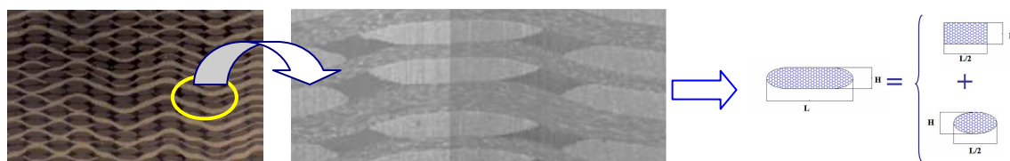
Figure 2 : observations microscopiques et modélisation de la section des mèches
