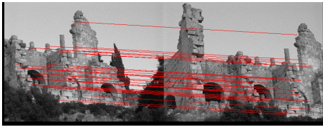
Figure 3: exemple d'appariement des points SIFT avec l'aide de la librairie ANN (crédit photo Y.Egels)
