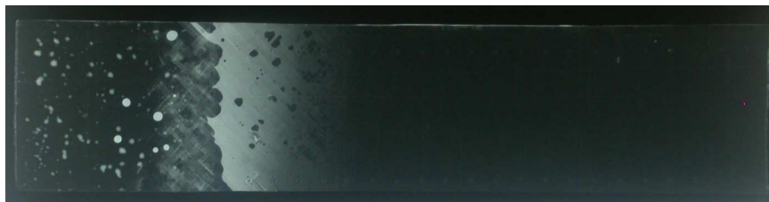
Fig. 7 : Radiographies X de l'éprouvettes ENF cousu (3mm)
