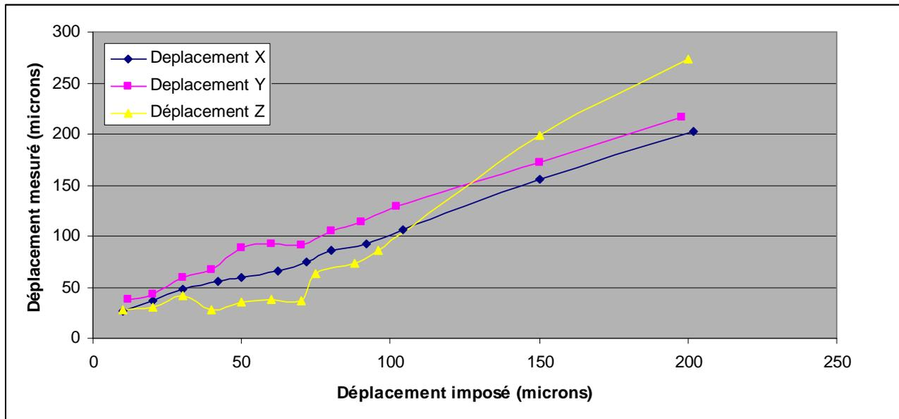
**Figure 3 : Résolution et erreur de justesse**
