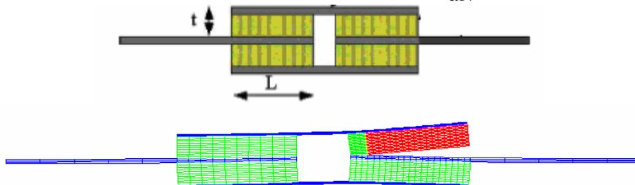
Fig. 2 : Modèle EF de cisaillement quatre blocs, interface endommageables.
