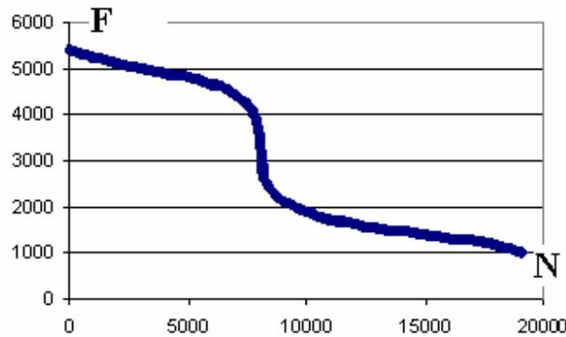
Fig. 4 : Cisaillement de fatigue (sens L), Nomex ECA 6,4mm, 64 Kg m<sup>-3</sup> (12.7 mm).
