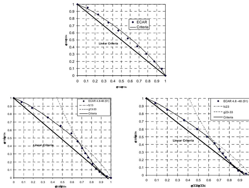
Figure 7 : Enveloppes de rupture linéaire ECA-R 48 Kg m-3
