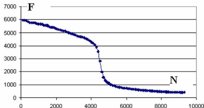
Fig. 3 : Cisaillement de fatigue (sens L), Nomex ECA-R 6,4mm,  $64 \text{ Kg m}^{-3}$  (40mm).
