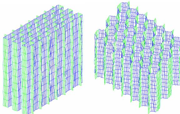
Fig. 1 : Modèle Cast3M de Nomex® ECA-R et ECA 6,4 mm 64 kg.m<sup>-3</sup>.
