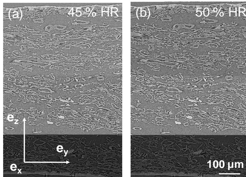
Figure 2 : (a) Coupe dans le plan de l'épaisseur ( $e_y$ ,  $e_z$ ) à HR = 20 %, (b) même coupe après passage à HR = 50 % du carton plat extraites d'un volume obtenu par microtomographie aux rayons X (ESRF, ligne ID19).
