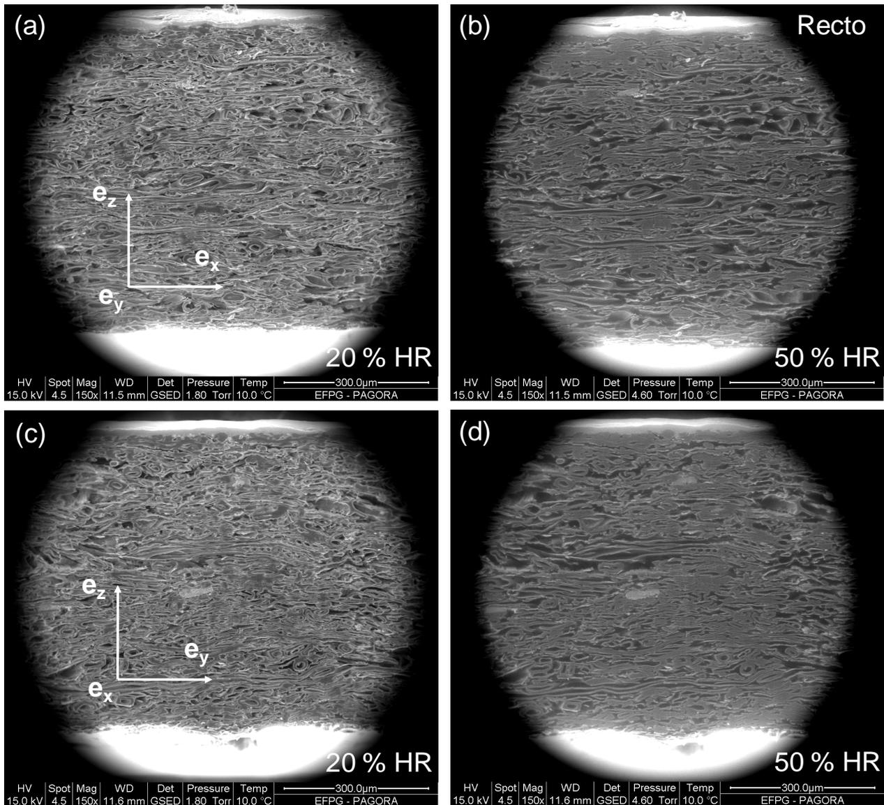
Figure 1 : (a) Coupe dans le plan de l'épaisseur ( $e_x$ ,  $e_z$ ) à HR = 20 % d'humidité relative, (b) même coupe après passage à 50 % HR, (c) coupe dans le plan ( $e_y$ ,  $e_z$ ) à HR = 20 % et (d) même coupe après passage à HR = 50 % du carton plat vues au MEBE.
