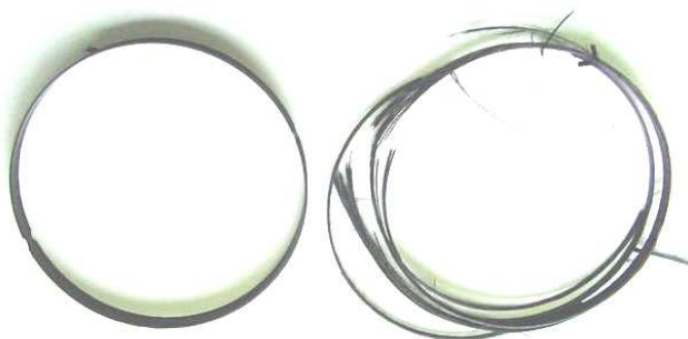
Fig. 8. Anneaux pour essais de traction avant et après rupture.
