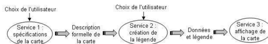
**Fig. 6** – Services Web reprenant les étapes de réalisation d'une carte et permettant d'interpréter le besoin et les goûts de l'utilisateur en carte sur mesure
