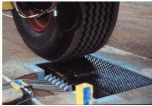
figure 2 d'après [7] a : ensemble de pointes instrumentées b : répartition des pressions de contact mesurées sous un pneumatique par cet ensemble.
