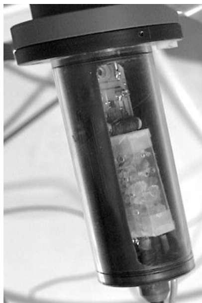
figure 17 Caractéristiques principales du capteur à principe capacitif
