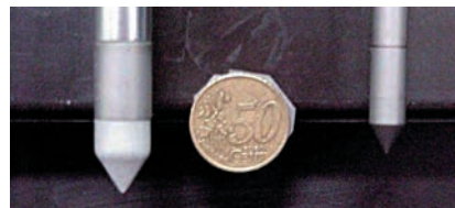
figure 21 Pointes pénétrométriques de diamètres 12 mm et 8 mm.
