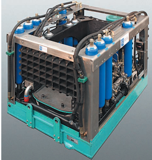
figure 35 Vue d'ensemble de la table vibrante embarquée.
