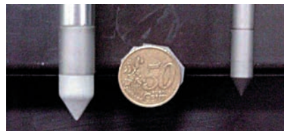
figure 21 Pointes pénétrométriques de diamètres 12 mm et 8 mm.
