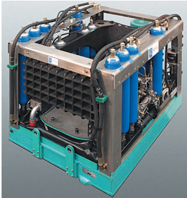
figure 35 Vue d'ensemble de la table vibrante embarquée.
