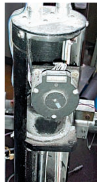
figure 24 Couple-mètre et moteur pas à pas monté sur la tige du vérin de fonçage.
