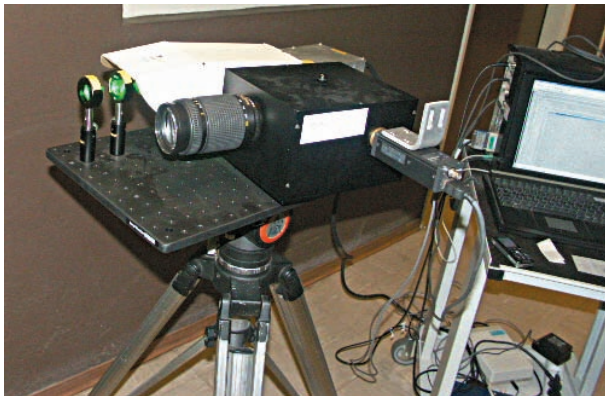
figure 2 Photographies du dispositif d'interférométrie shearographique a : en laboratoire b : sur site.
