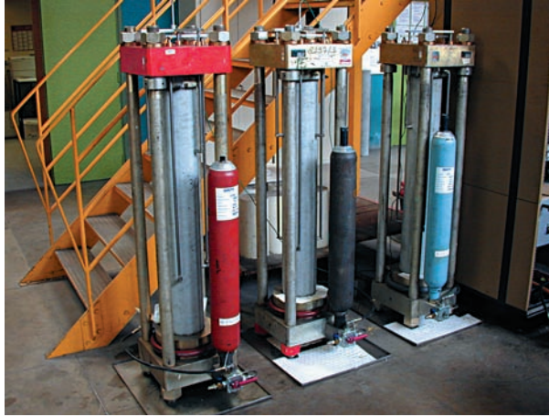
figure 12 Bâties de fluage en conditions ambiantes variables près de la poutre instrumentée.
