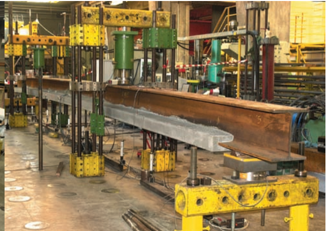
figure 21 Transfert de la précontrainte à la poutre mixte 51 h après le bétonnage.
