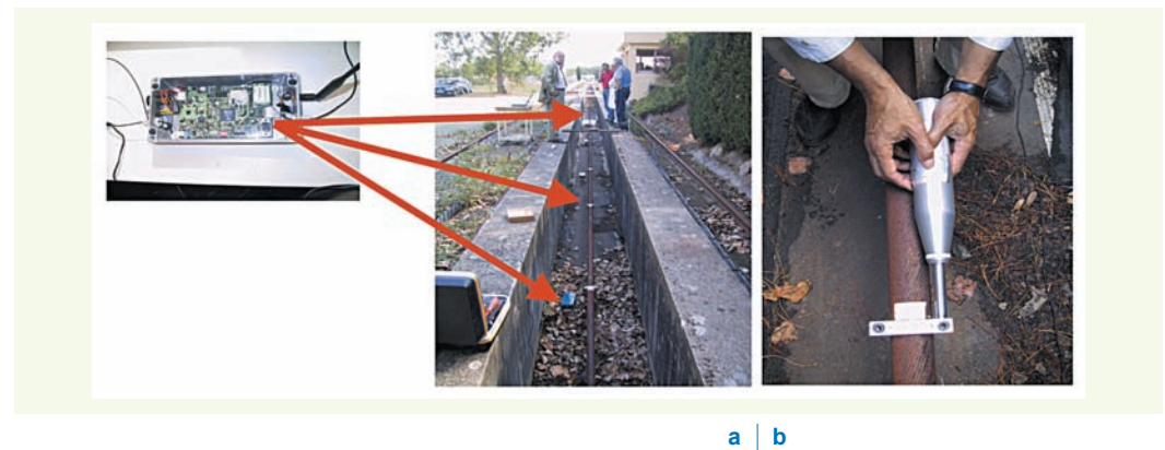
figure 17 Tests de transmission de données réalisés avec un système CASC équipé du protocole Zigbee a : placement des trois capteurs CASC sur le banc de test b : simulation de chocs.
