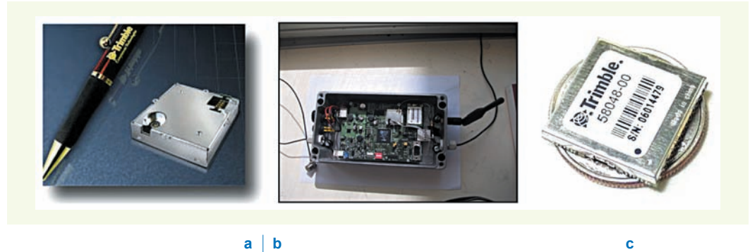
figure 7 Quelques modules GPS a, b : petits modules directement intégrables c : modules GPS en composants électroniques.
