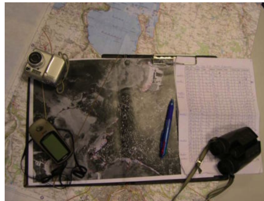
Illustration 3 – Fond orthophoto, carte topographique, stylo quatre couleurs, "planchette", appareil photo, jumelles et GPS : le matériel du parfait arpenteur du littoral
