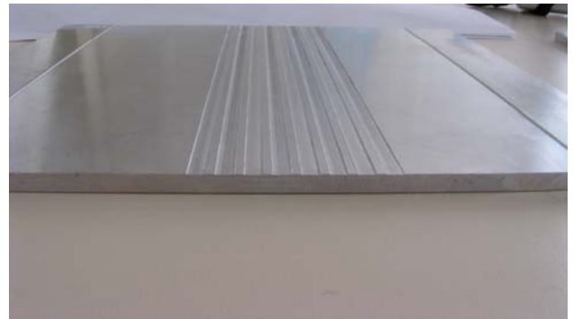
Figure 6 : Photographie de l'échantillon à stries rectangulaires.
