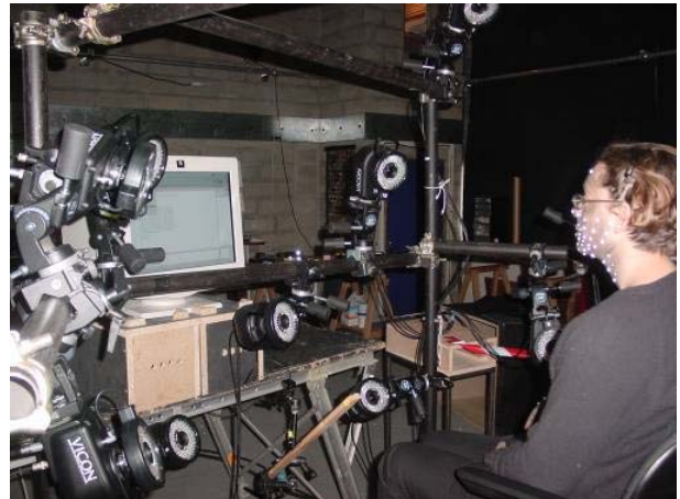
Fig. 5. Capture des mouvements du visage et de la main lors de l'énonciation de corpus lus. Les phrases, parfois difficiles à prononcer, avaient été préalablement enregistrées par une locutrice et étaient diffusées par haut-parleur. Ces consignes acoustiques évitent une situation trop proche de la lecture où le décodage du texte prend le pas sur l'expression.
