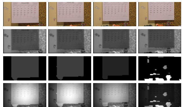
FIG. 4 – Cartes de saillance pour la séquence New Mobile and Calendar (segments 43 à 46), avec de haut en bas : images originales, cartes de saillance spatiale, cartes de saillance temporelle et cartes de saillance spatio-temporelle.
