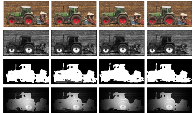
FIG. 3 – Cartes de saillance pour la séquence Tractor (segments 13 à 16), avec de haut en bas : images originales, cartes de saillance spatiale, cartes de saillance temporelle et cartes de saillance spatio-temporelle.
