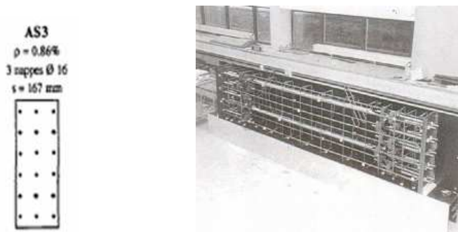
FIG. 1 – Répartition des aciers dans le tirant
