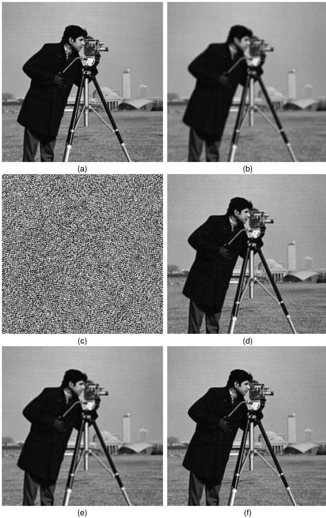
FIG. 7.7 – (a) Image originale “cameraman”. (b) Image floue (défocalisation de rayon 2 pixels) et bruitée. (c) Inverse généralisée (7.4.5). (d) Algorithme de Landweber, 100 itérations (7.4.6),  $SNR_{var} = 15,7dB$ . (e) Régularisation de Tikhonov (7.4.7),  $\lambda = 2$ ,  $SNR_{var} = 14,9dB$ . (f) Régularisation semi-quadratique ICM-DCT,  $\lambda = 2$ ,  $\delta = 15$ , 100 itérations,  $SNR_{var} = 18,4dB$ .
