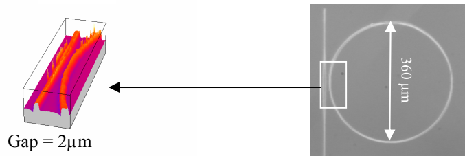
Fig.4 : Micro-résonateur en anneau inscrit sur photo-résine
