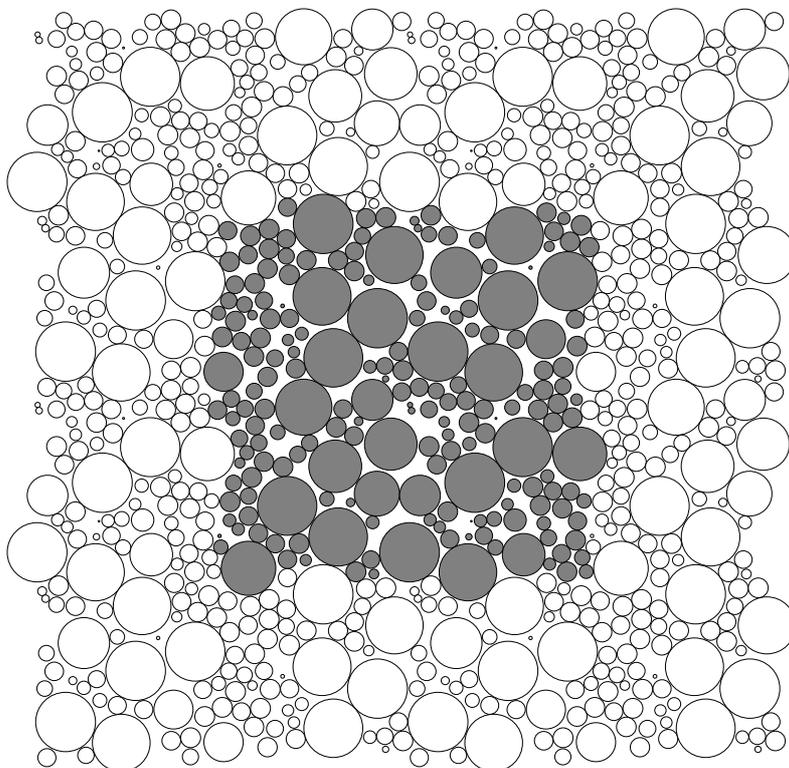
FIG. 1 – Vue en coupe d’un échantillon avec  $N = 2916$  et  $N_2 = 232$ . Les particules figurées en gris appartiennent à la cellule de base dans laquelle sont conduits les calculs, et qui se répète périodiquement.
