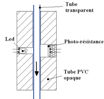
Figure 2 : Capteur optique.
