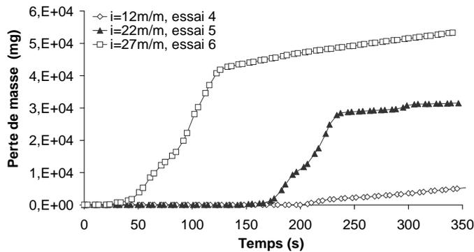
Figure 6 : Perte de masse en fonction du temps pour trois gradients différents
