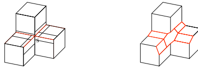
FIG. 7. Un objet difficile à chanfreiner avec alternance d'arêtes entrantes et sortantes au sommet S et le résultat correct de son chanfreinage.
