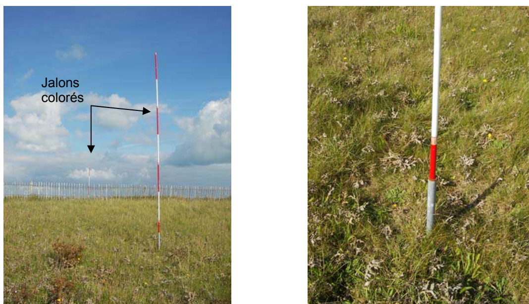
Figure 8. L'alignement de chaque profil est matérialisé par des jalons plantés au niveau des piquets repères en acier galvanisé
