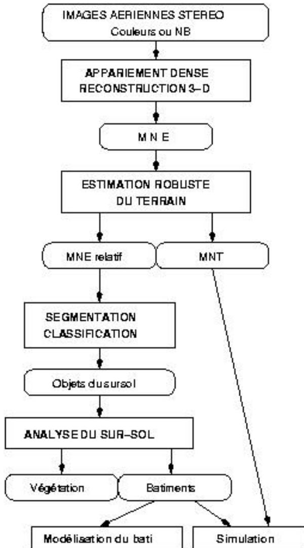
Fig. 1 – Chaîne de traitements : schéma synoptique.
