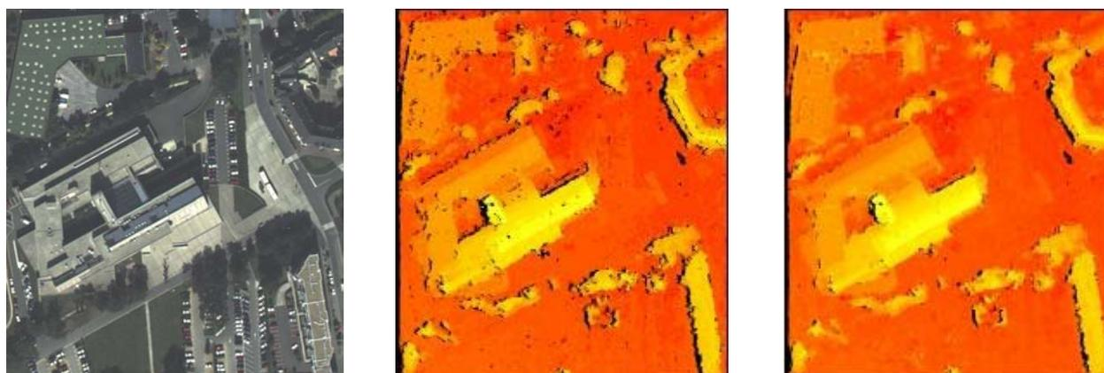
*Fig.3 – MNE calculé sur un couple stéréoscopique couleurs images de l'IGN, Rennes (image 650 x 720, résolution au sol 35cm par pixel).*
