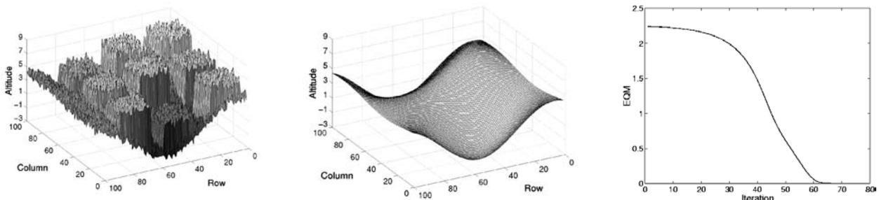
Fig. 4 – Simulation : MNE et MNT estimé , courbe de l'erreur quadratique moyenne au long des itérations.
