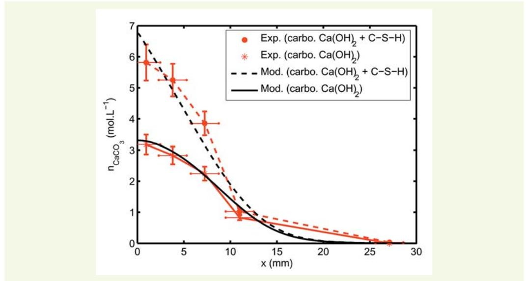
Le modèle de carbonatation montre que la profondeur pour laquelle le pH est égal à 9 au bout de 14 jours de carbonatation accélérée est voisine de 7 mm, valeur à comparer à la profondeur de carbonatation mesurée par pulvérisation de phénolphthaléine à la même échéance :  $9 \pm 1$  mm.
