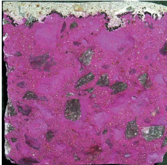
figure 3 Profondeur de carbonatation déterminée par pulvérisation de phénolphtaléine : exemple de l'éprouvette 10-2A.
