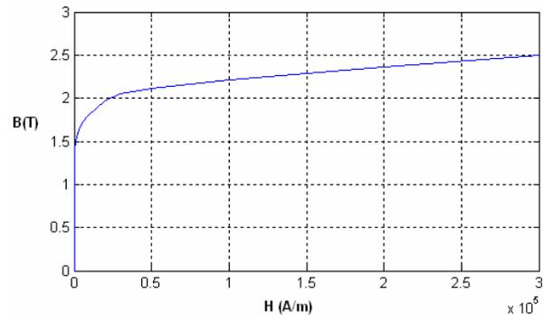
FIG. 2 Courbe B (H) du matériau M800-50A
