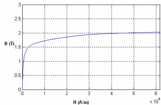
FIG. 3 Courbe B (H) du matériau SAE 1006
