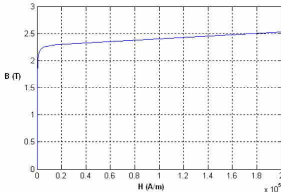
FIG. 6 Courbe B (H) du matériau AFK 502
