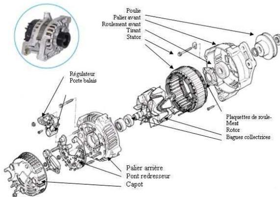
FIG. 1 Vue éclatée d'un alternateur à griffes
