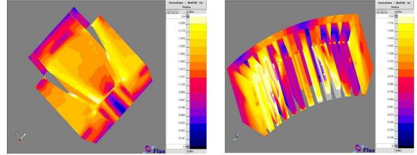
FIG. 7 Dégradé de l'induction magnétique au rotor et stator à 1800 tr/min
