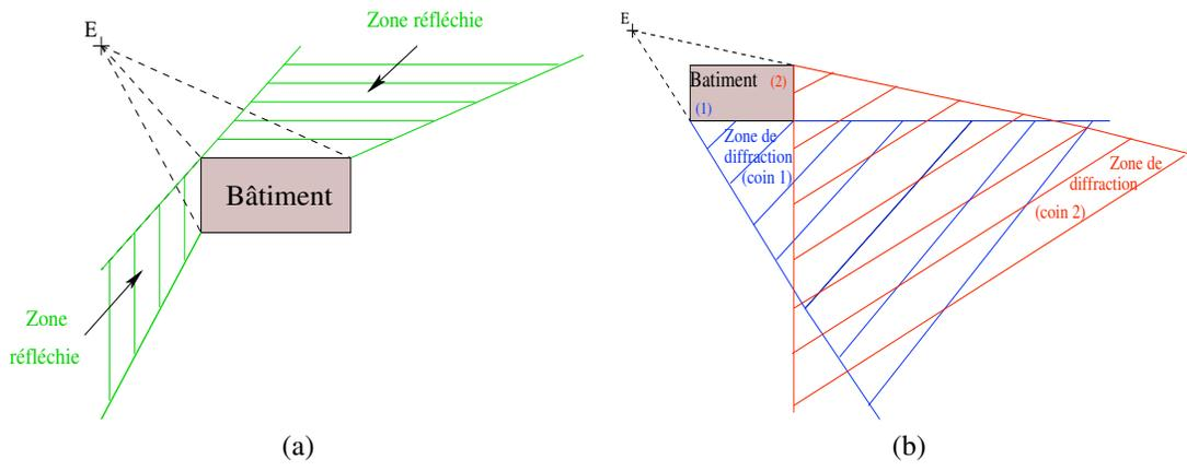
figure 21 – Zones réfléchies (a) et diffractées (b) par un bâtiment
