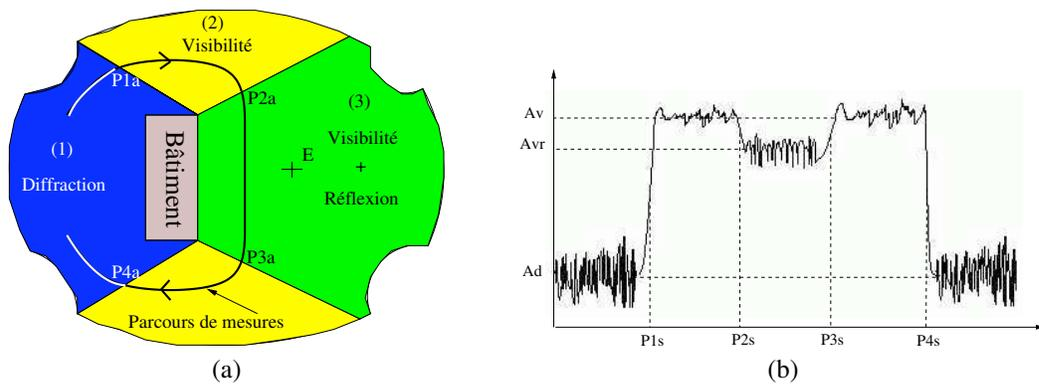
figure 2 – (a) Partition spatiale (b) Signal schématisé reçu sur le parcours de mesure
