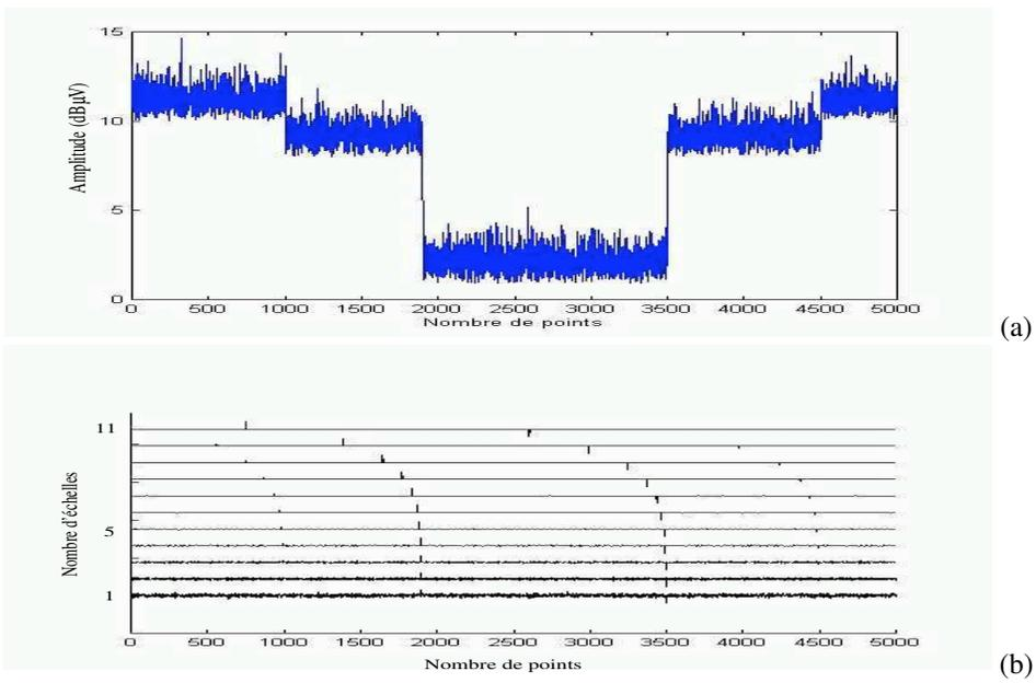
figure 27 – Segmentation d'un signal sur 11 échelles
