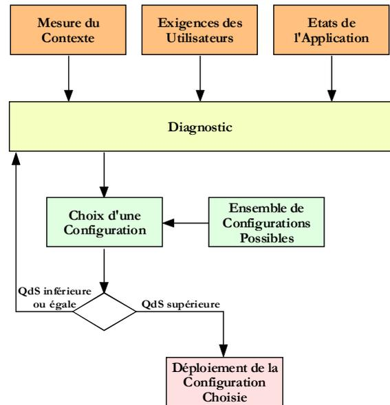
Figure 5. Fonctionnement de la plateforme de reconfiguration
