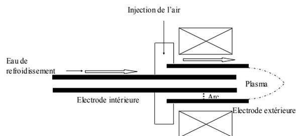
Figure 5 - Schéma de la troisième configuration de la torche à plasma. La cathode pénètre dans l'anode et une bobine magnétique enveloppe l'anode.
