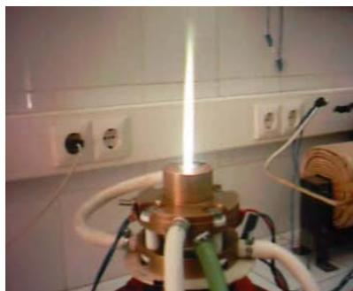
Figure 9 - Photographie du développement du jet de plasma de la torche. Le courant injecté dans la bobine est de 0 A.
