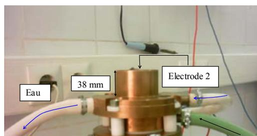
Figure 7 - Photographie de la torche (électrode avant a une longueur de 70mm)
