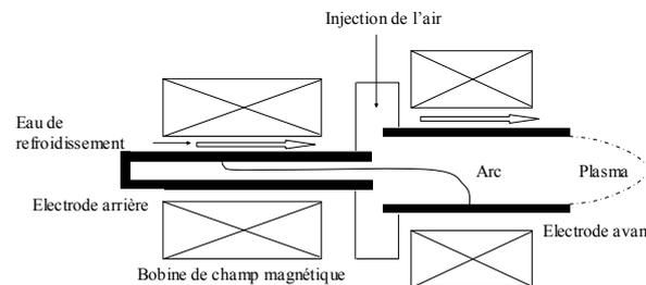
Figure 4 - Schéma de la deuxième configuration de la torche à plasma. Chaque électrode est enveloppée d'une bobine magnétique.
