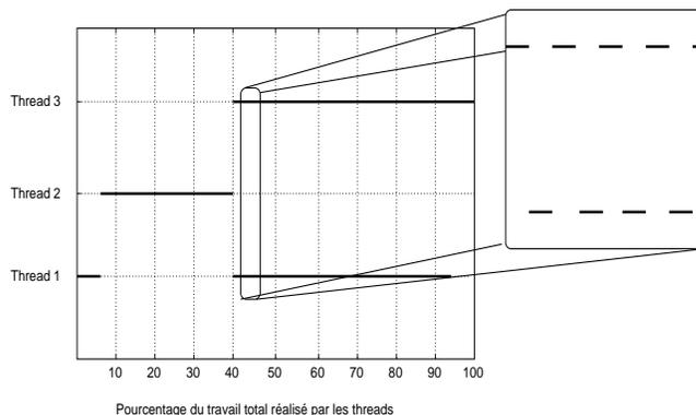
FIG. 1 – Ordonnancement utilisant les « *green threads* »
