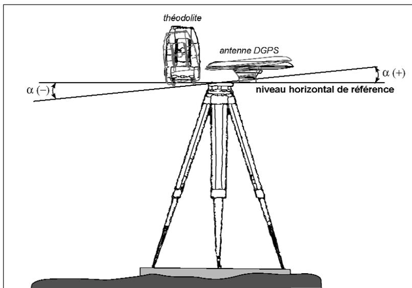
Figure 9: Mauvais maintien de la canne / réflecteur et/ou du mobile DGPS et décalage angulaire se répercutant sur la mesure en X,Y et Z.
