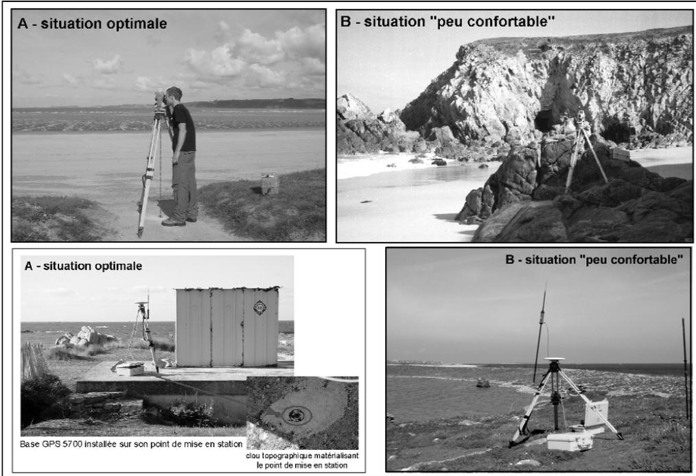
Figure 6: Clous topographiques matérialisant des points de calage installés sur différents types de supports stables
