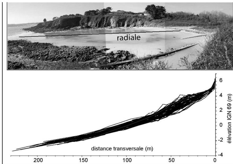
Le premier concerne les *enveloppes de profils de plage*, il offre une vision en deux dimensions des changements altitudinaux d'une plage (figure 2). Dans ce cas, la mesure s'effectue le long de radiale(s) perpendiculaire(s) au trait de côte. Il est alors important de connaître la marge d'erreur altitudinale (Z) induite par la mesure.
