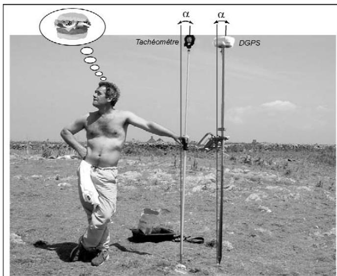
Enfin, la troisième source d'erreur provient d'un mauvais positionnement du mobile : canne et réflecteur pour la mesure au théodolite ; canne « automatisée » pour le DGPS (figure 9). Ceci joue sur la position en X,Y et Z du point.
