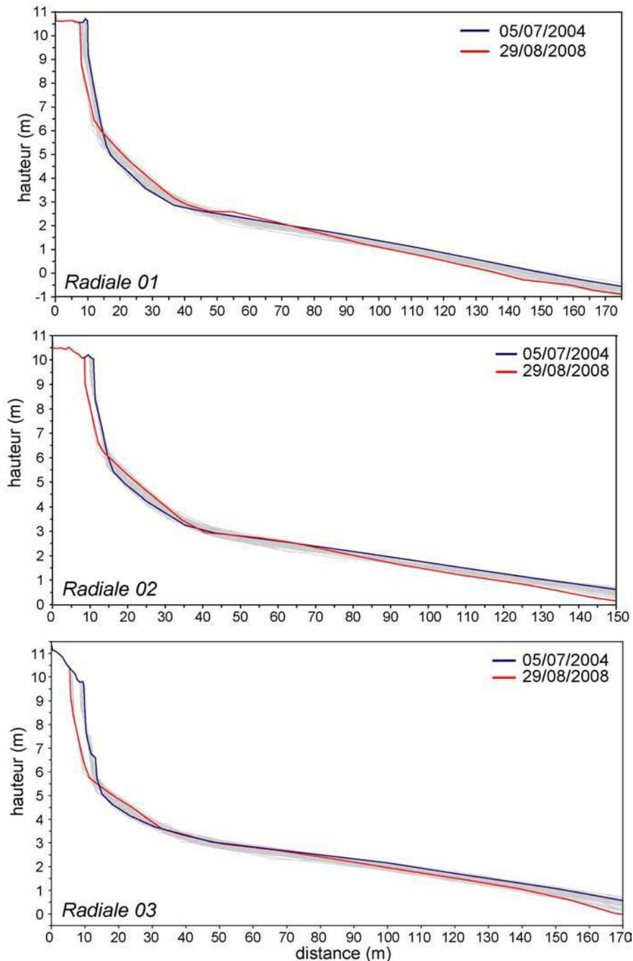
Figure 3 – Enveloppes de profils de plage / dune pour les trois radiales
