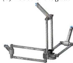
Fig. 2. Exemples de manipulateur parallèle à 3 ddl
