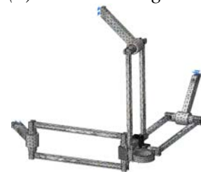
Fig. 2. Exemples de manipulateur parallèle à 3 ddl
