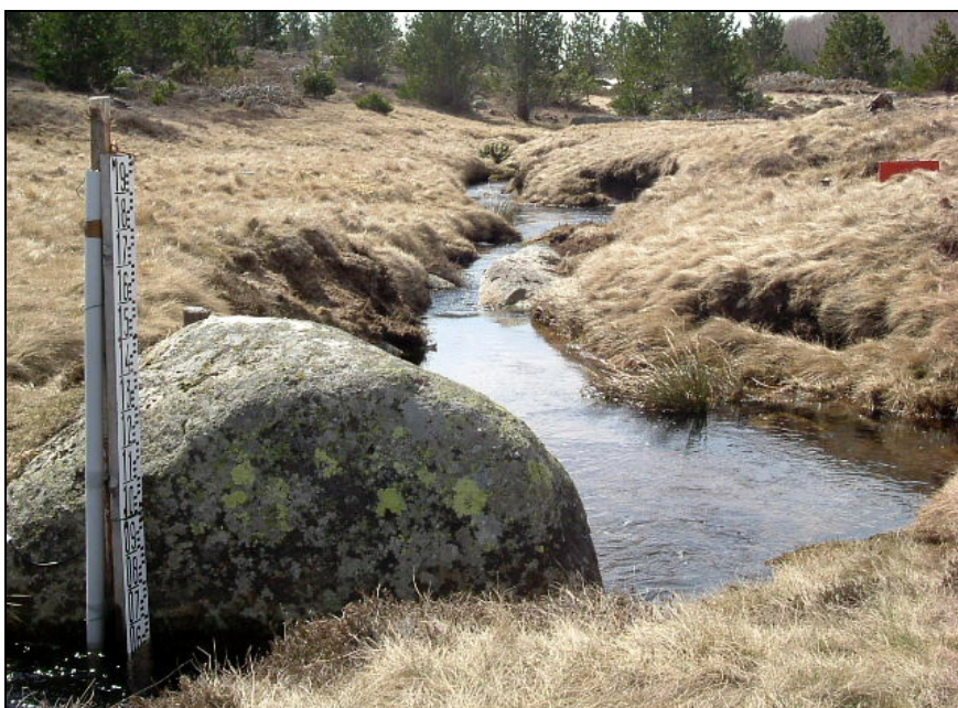
Photo 3 - Station hydrométrique sur le ruisseau de la Pudissine (vue vers l'aval).
