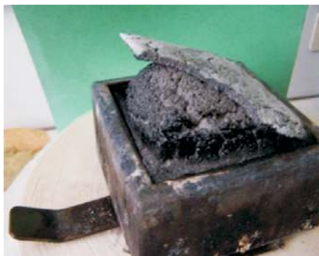
Figure 5 - Illustration du phénomène d'intumescence.
