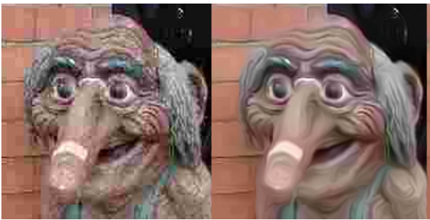
(c) Suppression des artefacts JPG sur une image couleur. (1 itération, temps de calcul : 13 seconds)
