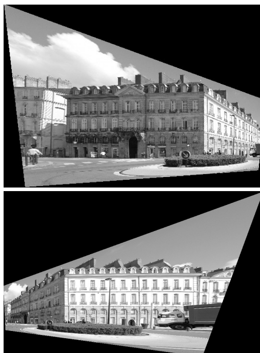
Figure 8 : Résultats de l'ortho-rectification automatique de la figure 3(a) selon les plans des façades déterminés par les deux groupes de directions horizontales détectées automatiquement par l'algorithme développé.
