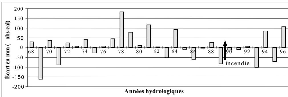
Figure 3 - Écart entre les écoulements annuels du bassin versant du Rimbaud observés et calculés par la relation R2 (pluies annuelles du bassin versant du Valescure).
