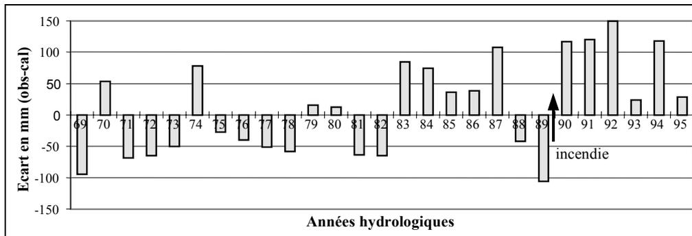
Figure 8 - Écarts entre les écoulements annuels du bassin versant du Rimbaud observés et calculés par le modèle journalier GR3J (pluies du bassin versant du Rimbaud).
