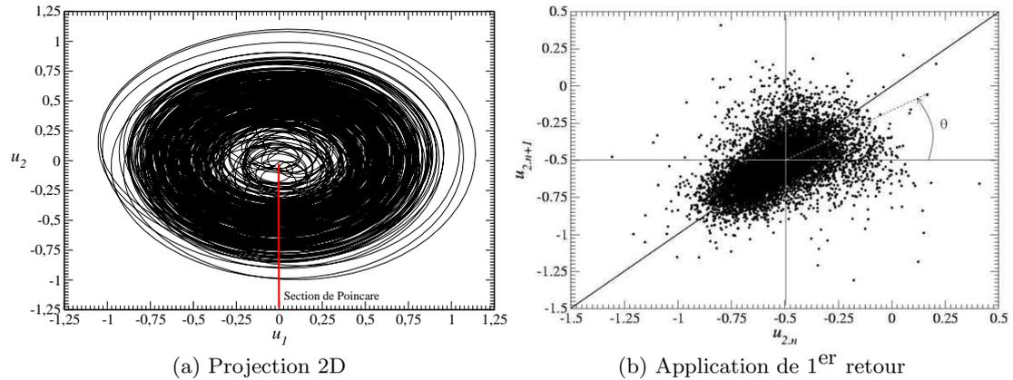
**Fig. 2.** Portrait de phase construit sur les deux premières composantes principales de la matrice des retards, construite sur le signal LDV, et application de premier retour dans la section de Poincaré.
