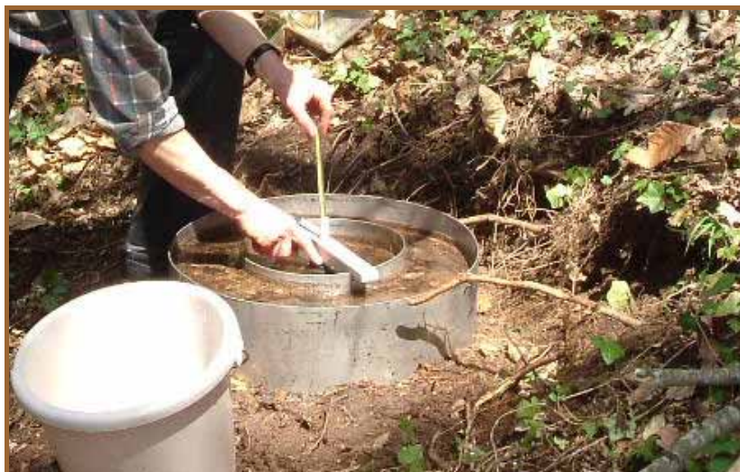
Photo 26 - Essai au double anneau à proximité des piézographes de la Vallée Obscure. (cliché : J.F. DIDON-LESCOT)
