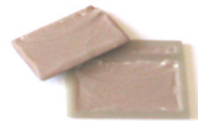
Figure 5 : Vue du substrat DCB après rupture de l'AIN
