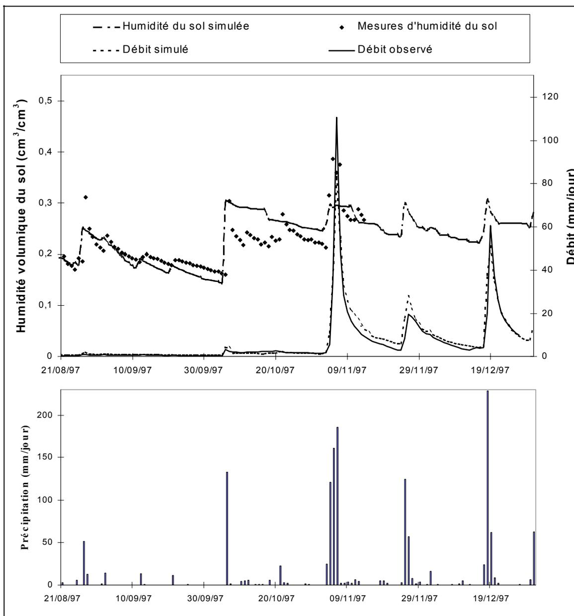
Figure 7 - Évolution des valeurs de l'humidité calculées pour la couche globale du sol et des mesures obtenues par sondes capacitatives sur le bassin versant de la Latte.
