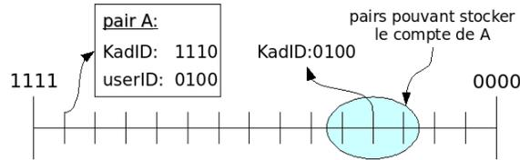
Fig. 1. Stockage d'un compte dans la DHT
