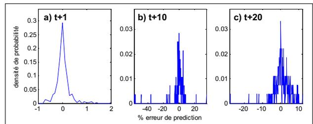
Figure 6. Modèle 2 - distribution de l'erreur de prédiction pour a)  $prév=1$ , b)  $prév=10$ , c)  $prév=20$
