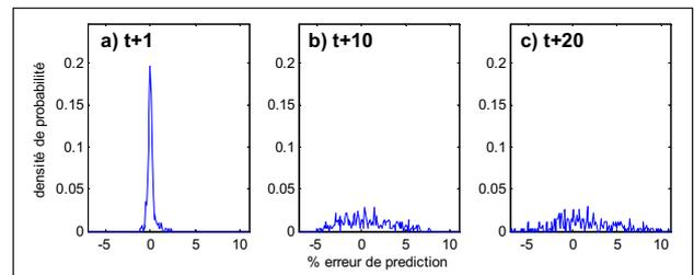
Figure 5. Modèle 1 - distribution de l'erreur de prédiction pour a)  $prév=1$ , b)  $prév=10$ , c)  $prév=20$
