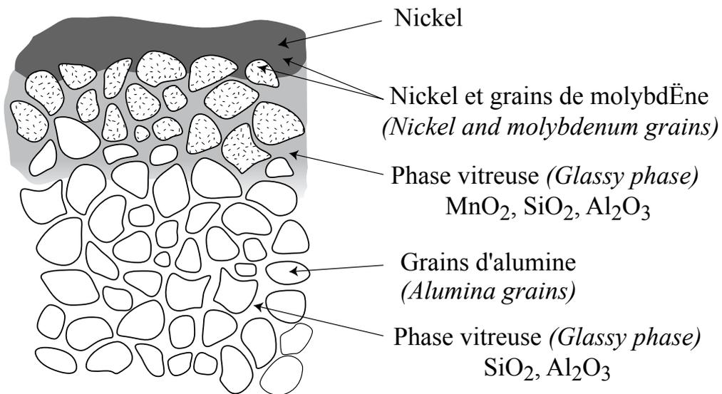
FIG. 3. Métallisation d'une alumine à l'aide du procédé moly-manganèse.
