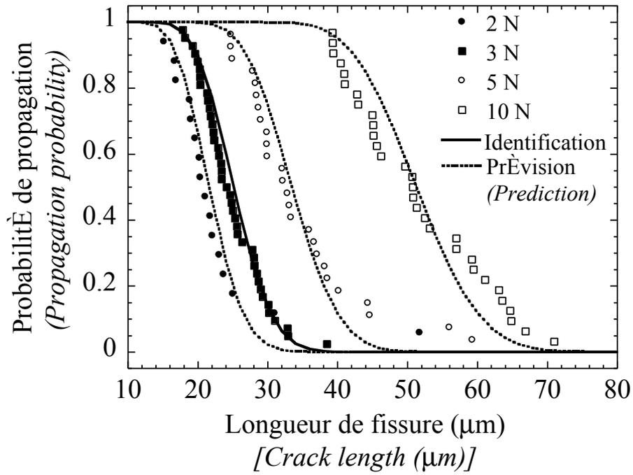
FIG. 8. Probabilité de propagation en fonction de la longueur des fissures créées par micro-indentation avec quatre charges différentes (temps d'application de la charge : 15 s).
