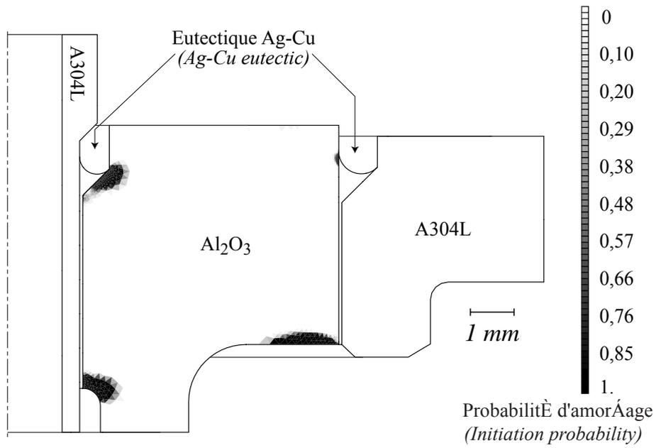
FIG. 5. Probabilité de rupture à  $t = 0^+$  (*i.e.*, fin de cycle de refroidissement) en chaque élément du maillage.
