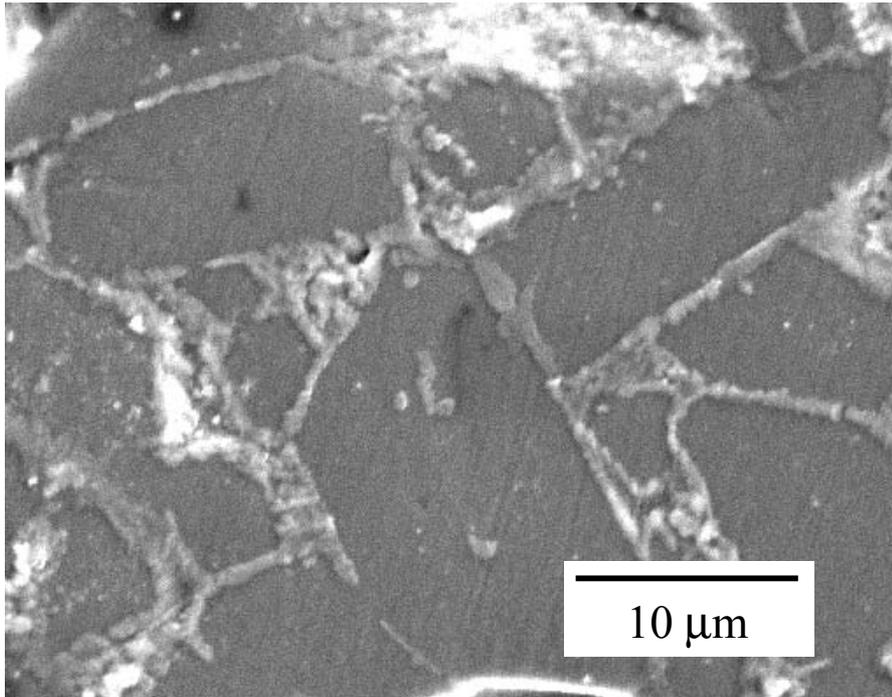
FIG. 2. Alumine utilisée avec une taille moyenne de grain  $1/\lambda$  de l'ordre de  $2 \mu\text{m}$ .
