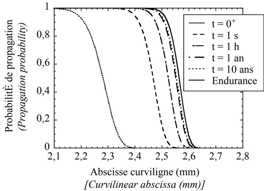
FIG. 13. Propagation sous-critique de la fissure associée à la singularité n°5 en un temps inférieur à  $t$ .
