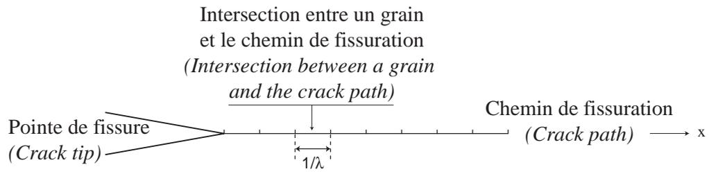
FIG. 6. Intersection entre le milieu et le chemin de fissuration.
