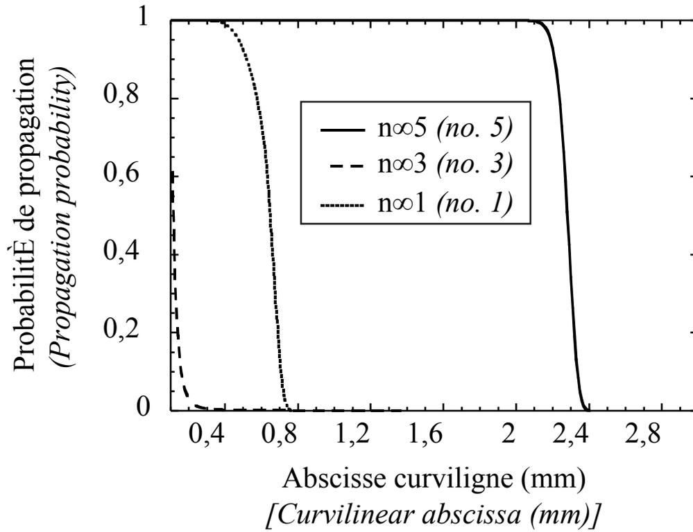
FIG. 11. Probabilités de propagation le long des chemins de fissuration à la fin du refroidissement (*i.e.*,  $t = 0^+$ ).
