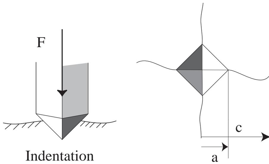
FIG. 7. Fissures générées par l'indentation d'un matériau fragile.
