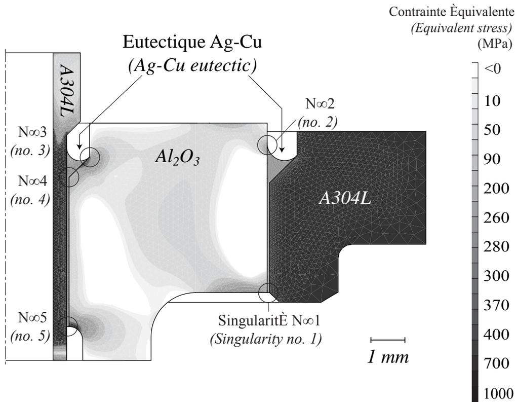
FIG. 4. Contraintes résiduelles dans l'assemblage après le cycle de refroidissement.
