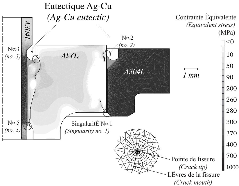
FIG. 10. Contraintes résiduelles dans l'assemblage après le cycle de refroidissement avec propagation de fissures. Zoom du maillage au voisinage de la pointe de l'une fissure.
