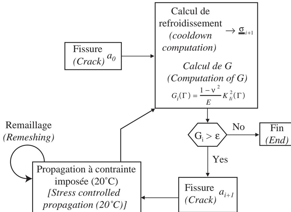
FIG. 9. Démarche suivie pour la simulation de la propagation des fissures.
