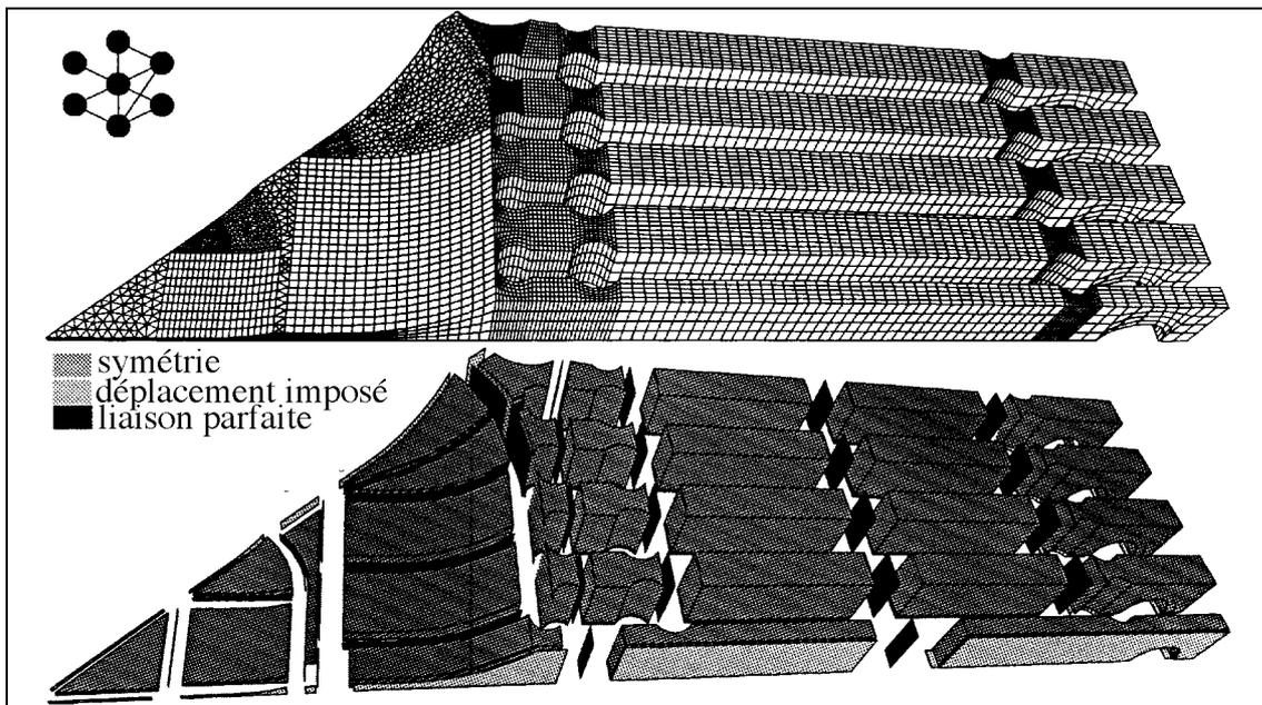
Figure 3 : maillage et partitionnement d'un seizième de l'éprouvette
