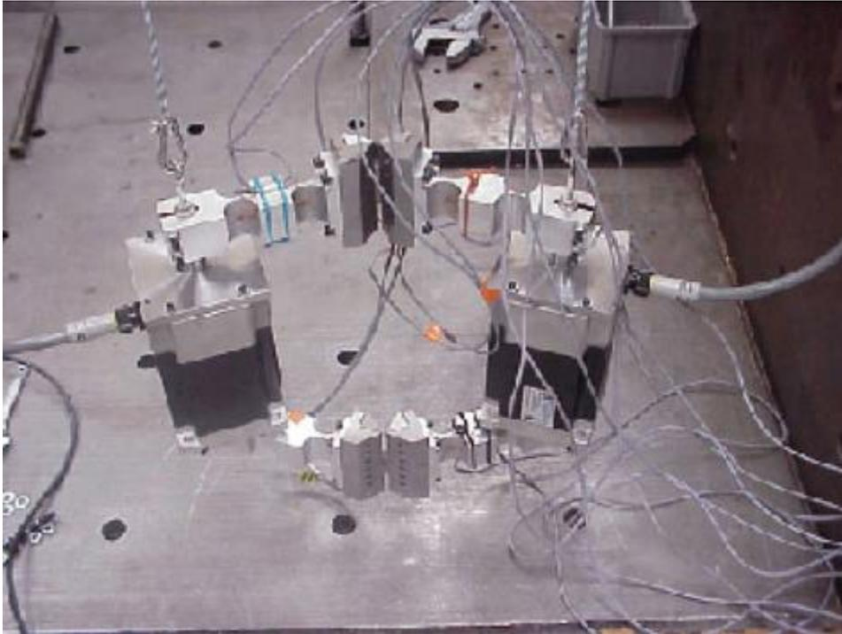
*Machine de flexion pure, Image : LMT-Cachan La particularité du dispositif est qu'il ne possède pas de bâti : il est constitué de deux moteurs rotatifs pas à pas identiques à axes parallèles ; l'état de flexion pure est assuré par l'antisymétrie du dispositif. Brevet n° : US2005241405, auteurs : Sylvain Calloch, David Dureisseix, Gilles Arnold, Inaki Zudaire Rovira. <http://lmt.ens-paris-saclay.fr/version-francaise/appui-a-la-recherche/le-centre-d-essais/la-machine-de-flexion-pure-172016.kjsp>*
